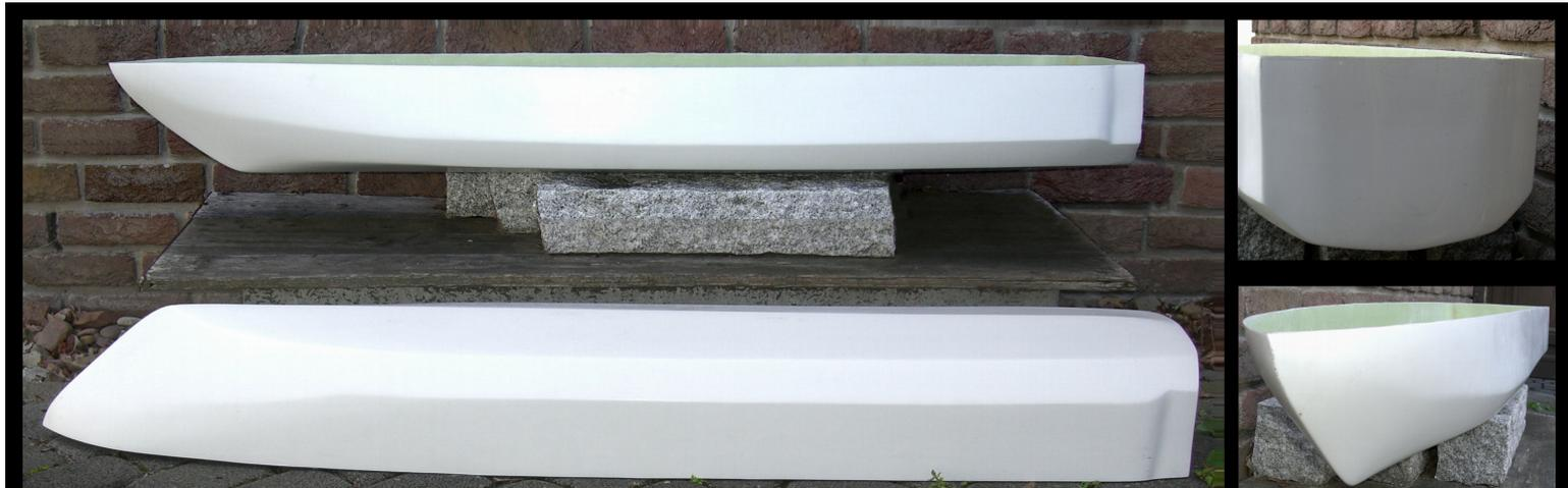
**GFK-Rumpf für SEA KING - Wandstärke 3 mm - Länge 1580 mm - Breite 300 mm - Höhe 185 mm**
